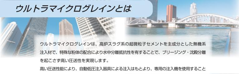
で継続的に高圧力で注入することが可能です。 ウルトラマイクログレインは従来の無機系注入材では困難であった、微細なひび割れ、 ジャンカ等の脆弱部やコンクリート構造物の奥まで注入充填が可能です。
