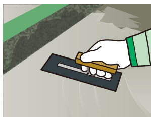
コテ塗り施工
